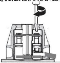
以帽式设计为例, 电容器均只能作为一个独立的分支, 不能在电容器的一端连接负载 (放电电阻除外)。
